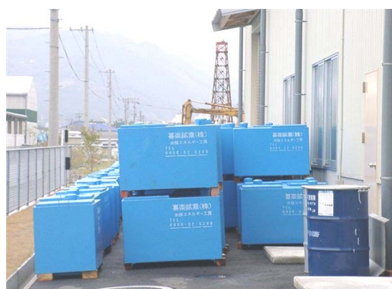
写真2 廃油専用回収ボックス
